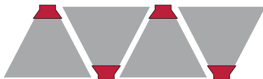
Схема озвучивания помещения обычным настенным громкоговорителем
