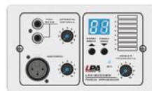
LPA-8000BW Панель управления звуком для LPA-MATRIX-8000, лин. и микр. входы
