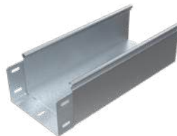
ML-LNM H100 В 50–600; L 2000/3000; Лоток неперфорированный высота борта 100 мм
